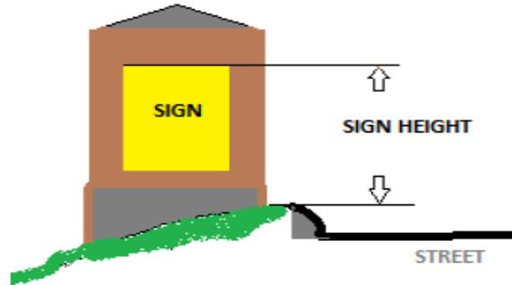
La altura de un signo se mide desde el punto más alto de una cara de signo hasta el grado adyacente más alto en la base del signo. La altura de la estructura del signo no excederá la altura de la Cara en más de veinte por ciento (20%).
